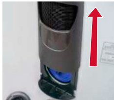
Blende zum Entfernen nach oben schieben
